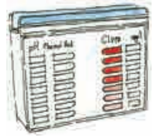
รูป 34 อุปกรณ์เทียบวัดคลอรีนคงเหลืออิสระ
