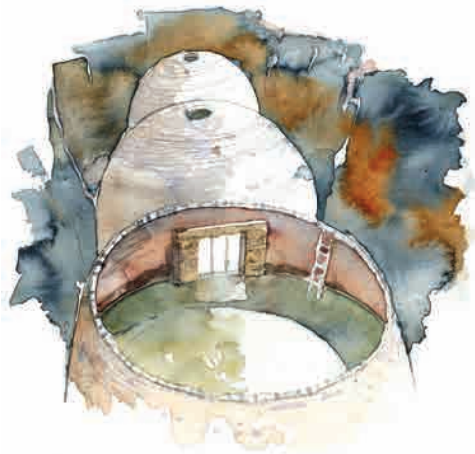
รูป 3 ระบบแก๊สชีวภาพขณะกำลังก่อสร้างที่เรือนจำกลางกิตารามา (Gitarama) ประเทศอินเดีย
