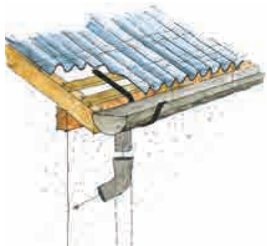
รูป 21 การติดตั้งรางน้ำฝน
